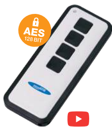
Mini-Novotron 524* 4-Kanal, 433 MHz, KeeLoq-Wechselcode
