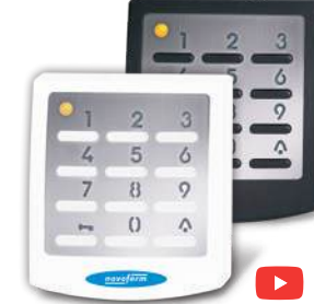
Funk-Codetaster Signal 218 10 Codes, 433 MHz, KeeLoq-Wechselcode mit Edelstahlblende, hinterleuchtet, aus UV-beständigem Material, wahlweise in weiß oder schwarz
