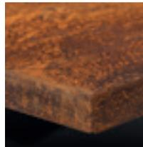
Cortenstahl ist ein natürlich korrodierendes Material. Die charakteristische Patina entsteht durch einen stetigen Wechsel von trockener und feuchter Witterung. Die Entwicklung beginnt nach 3-4 Wochen und ist nach 1-2 Jahren abgeschlossen.
